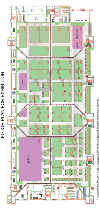
\* FOR BALANCE AREA LOAD BEARING CAPACITY IS 5000kg (per SQM)
